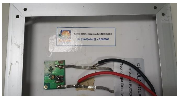
Figura 14: Montagem do resistor nos terminais da célula solar.
