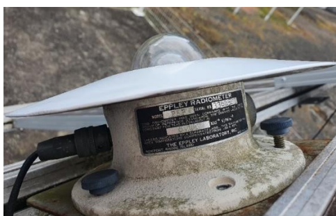
Figura 16: Placa de identificação da constante do piranômetro Eppley.
