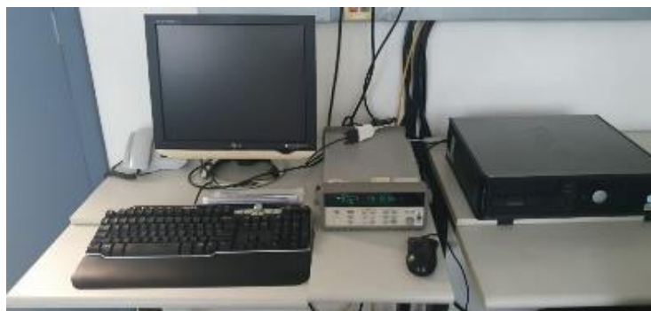
Figura 20: Aparato de medição e armazenamento de dados: datalogger Agilent 37940A.
