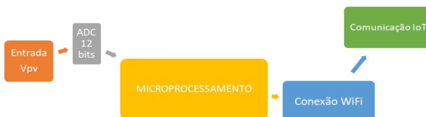
Figura 22: Diagrama de blocos da arquitetura proposta para o hardware .
