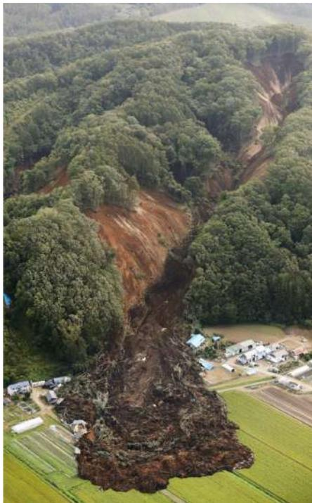
Figura 1.5: Desmoronamento causado por terremoto no Japão em 2018. Região de espalhamento observado ao final do desmoronamento. Fonte: Bressan (2018).
