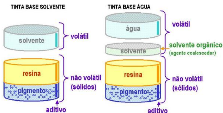
Figura. 3.1. Composição das tintas base solvente e tintas base água para construção civil.
