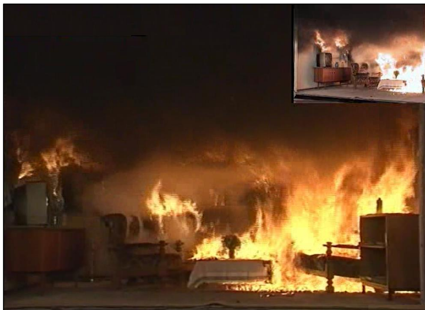
Figura. 3.4. O flashover , 722 °C, em ambiente preparado para testes – 12 min e 18 s.
