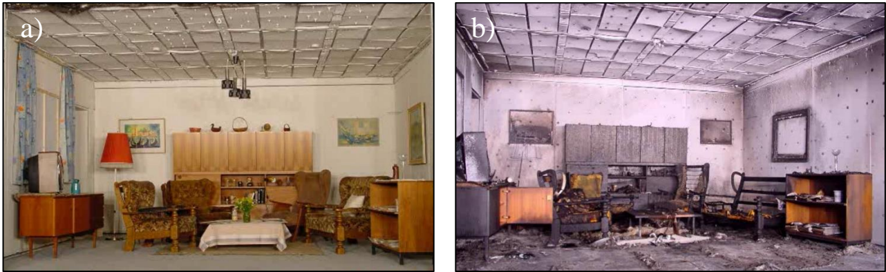
Figura. 3.3. Ambiente de testes, pré (a) e pós (b) flashover – momento: 0 a 12 min e 49 s.
