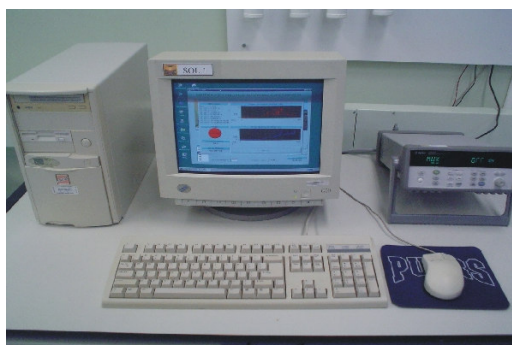
Figura 8. Principais equipamentos que compõem o sistema de aquisição de dados automatizado para a caracterização experimental do sistema fotovoltaico.
