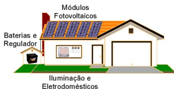
Figura 1. Esquema representando um sistema fotovoltaico autônomo.
