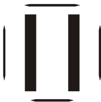
Figura 2 - Desenho da máscara com as barras coletoras posteriores de 10 mm de largura.
