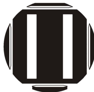
Figura 3 - Desenho da máscara utilizada para depositar a pasta de Al em toda a superfície com exceção das barras coletoras de 10 mm de largura.
