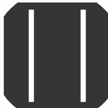
Figura 5 - Desenho da máscara utilizada para depositar a pasta de Al em toda a superfície com exceção das barras coletoras de 3,8 mm de largura.
