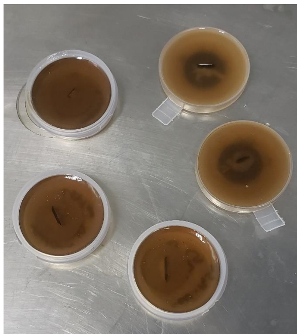
Figura 16. Amostras embutidas em resida de poliéster.
