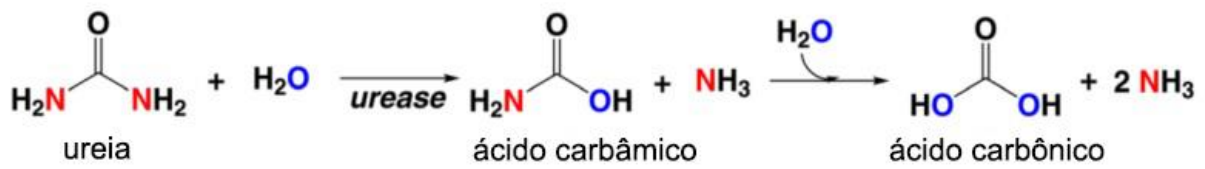
Figura 3.1. Reação da hidrólise da ureia catalisada pela urease. Fonte: adaptado de Svane et al. , 2020.
