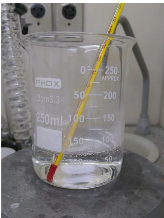
Figura 3. Água Milli-Q no béquer, sendo aquecida até a temperatura de 50°C. Fonte: o autor (2021).
