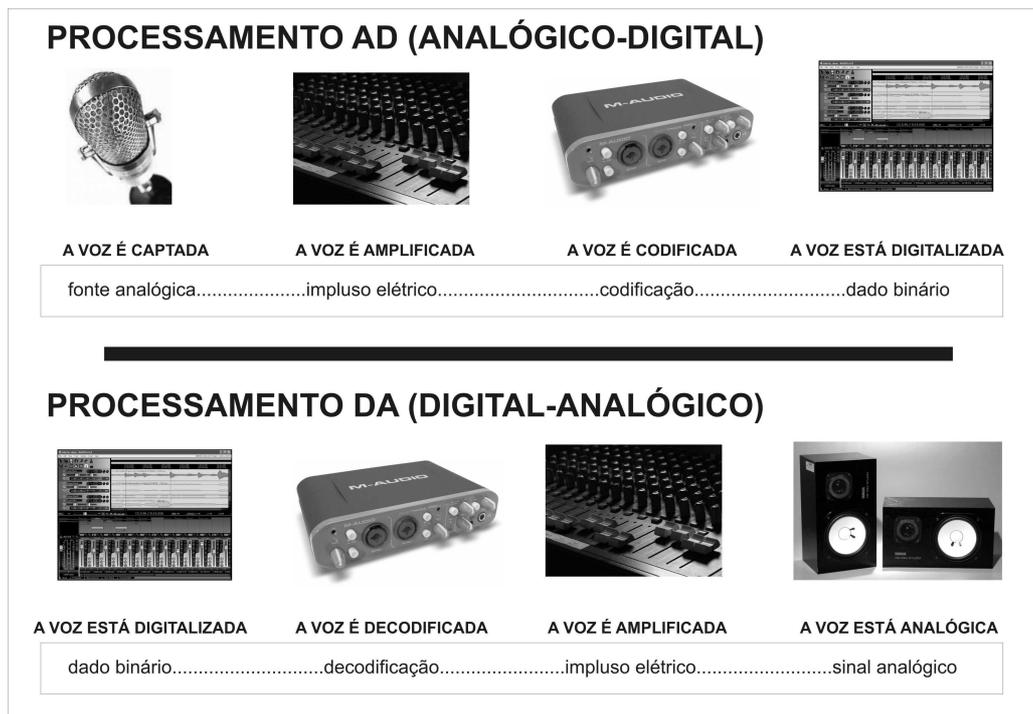
Fig. 53 – Processo AD/DA – Fonte: (PALUDO, 2010)
