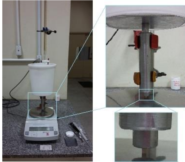
Figura 4.1. Equipamento experimental para realização dos testes de resistência mecânica
