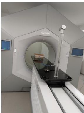
Figura 1. Phantom de placas de água sólida e acrílico junto com a câmara de ionização.
