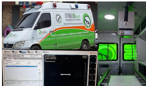
Fig. 1 Imagem da unidade móvel (superior à esquerda), com sistema de radiologia veterinária (à direita); tela com o sistema de aquisição das imagens com imagem do phantom de calibração (inferior à esquerda)
