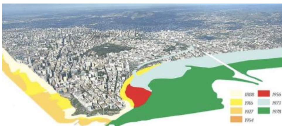
FIGURA 15 - Ilustração da evolução dos aterramentos nas margens do Guaíba
