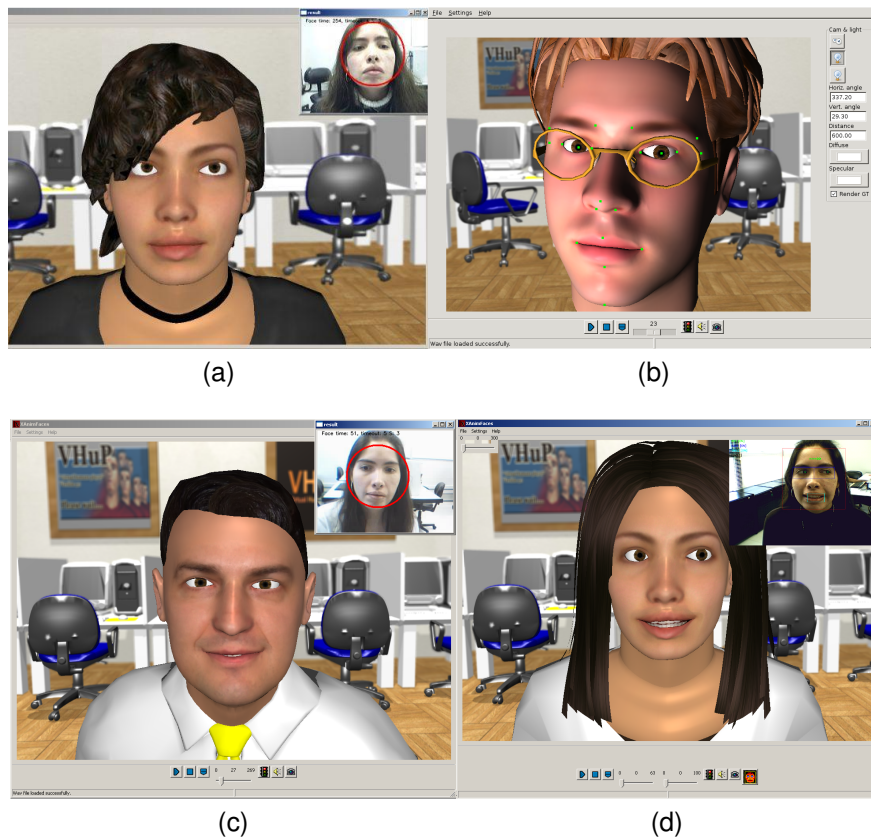
Figura 5.4: Snapshots das aplicações desenvolvidas com o framework : a) Follower Eyes , em que o personagem virtual segue a face detectada do usuário com os olhos; b) Gerador de ground truth , para avaliação de algoritmos de CV; c) Diretor Virtual, em que o personagem virtual saúda e informa os usuários de acordo com a detecção e permanência da face; e d) Espelho Virtual, em que são detectadas algumas ações como sorriso e direção horizontal dos olhos e a personagem virtual “imita” a ação (um estudo preliminar de PDA).
