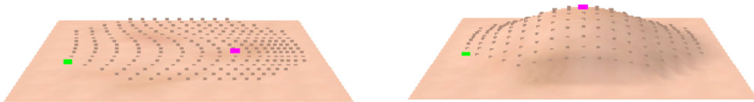
Figura 4.6: Ilustração dos elementos de uma região para a aplicação de uma RCF. O ponto rosa representa o ponto de controle (FP) e o verde é um dos pontos mais distantes do FP (já que a zona é circular nesse exemplo).
