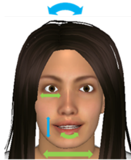
Figura 5.5: Ações faciais detectadas na aplicação “Espelho Virtual”, que constituem os parâmetros alto-nível de animação.
