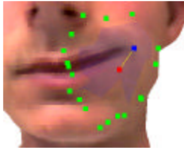
Figura 4.7: Ilustração dos elementos de uma região para a aplicação de um RBF, chamadas de GDE por (89). O ponto vermelho representa o ponto de controle na sua posição inicial, enquanto o azul representa o ponto de controle após o deslocamento. Os pontos verdes são os pontos-âncora, que delimitam o GDE.
