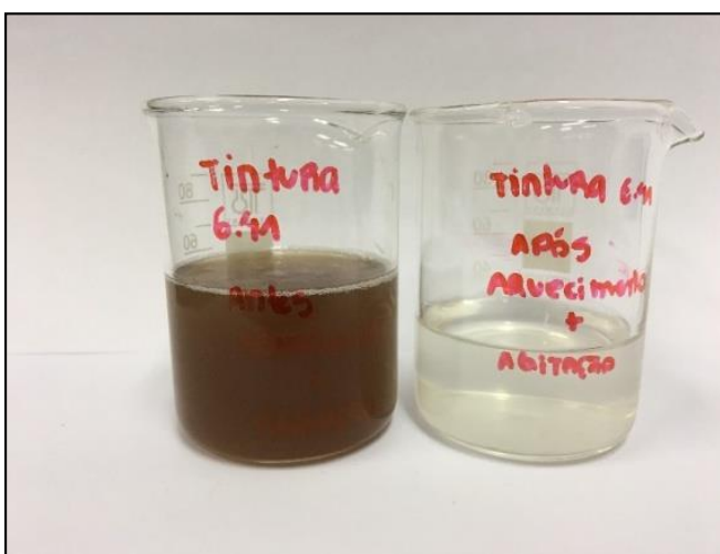
Figura 5.5. Efluente marrom antes e após 60 minutos de contato com carvão ativado sob aquecimento ( 5\text{mg}\cdot\text{L}^{-1} a 60^\circ\text{C} ).
