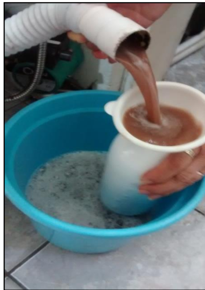
Figura 4.2. Coleta do efluente de coloração na saída da tubulação de um lavatório do Salão de Beleza A.
