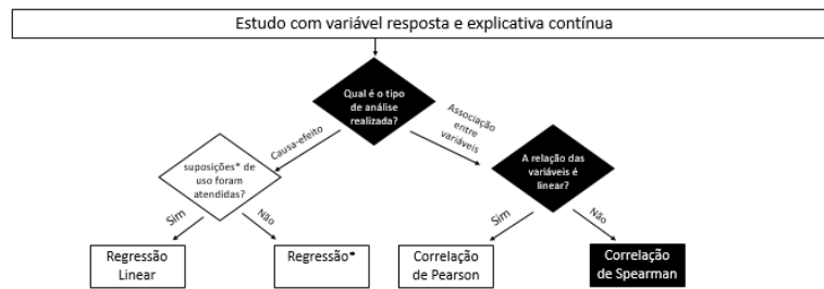
Figura 9.33 – Resultado da segunda escolha do fluxograma para ser utilizado quando o objetivo é verificar a relação entre duas variáveis contínuas (que não apresentam comportamento linear).
