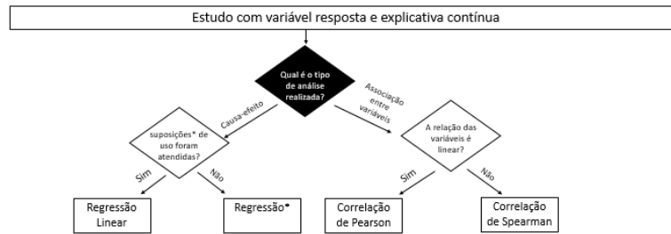
Figura 9.35 – Início do fluxograma para ser utilizado quando o objetivo é verificar a relação entre duas variáveis contínuas.
