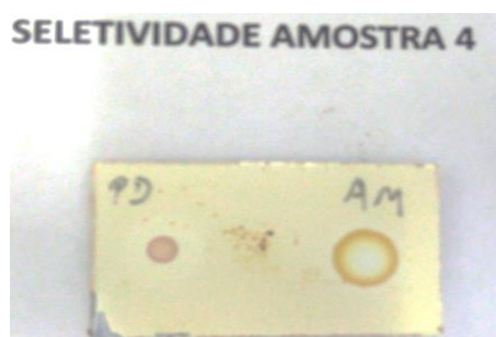
Figura 46: Resultado da análise de especificidade. Lado esquerdo: padrão no limite de especificação. Lado direito: amostra (Fonte: o autor, 2020).
