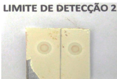
Figura 47: limite de detecção de 100 \mu\text{g}/\text{mL} (Fonte: o autor, 2020).
