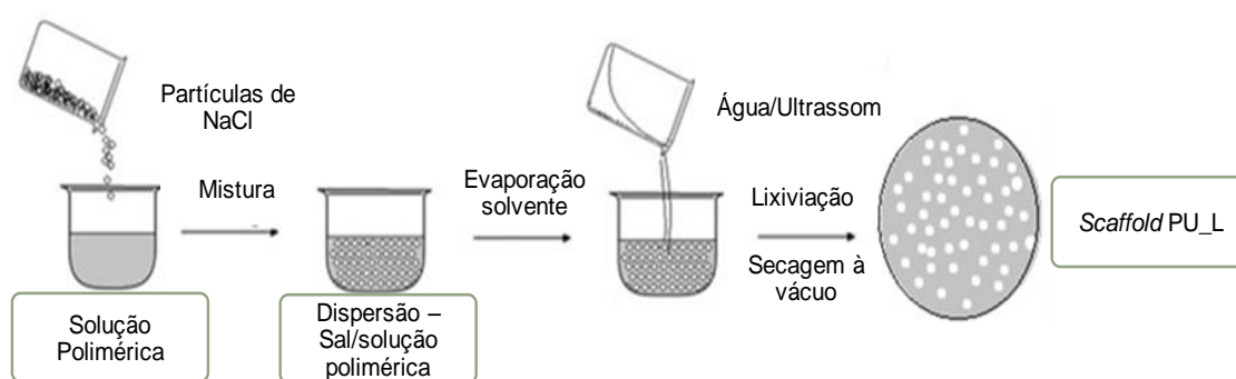
Figura 4.3. Esquema simples das etapas de obtenção de scaffolds a partir da técnica de lixiviação (JANIK et al., 2015).
