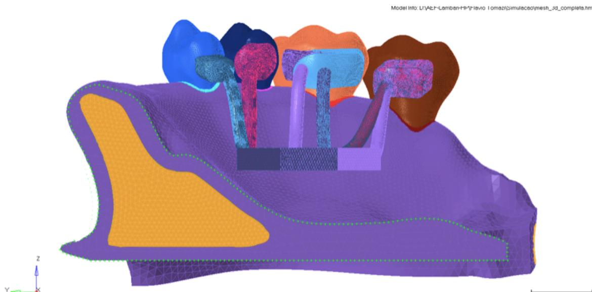
Fig. 7 - Local da aplicação de “Elementos de barra” simulando resistência à abertura do modelo
