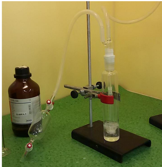
Figura A1. Frasco lavador contendo n-butanol, borbulhado com ar sintético ( 1,0 \text{ L min}^{-1} ) conectado à cápsula coletora.
