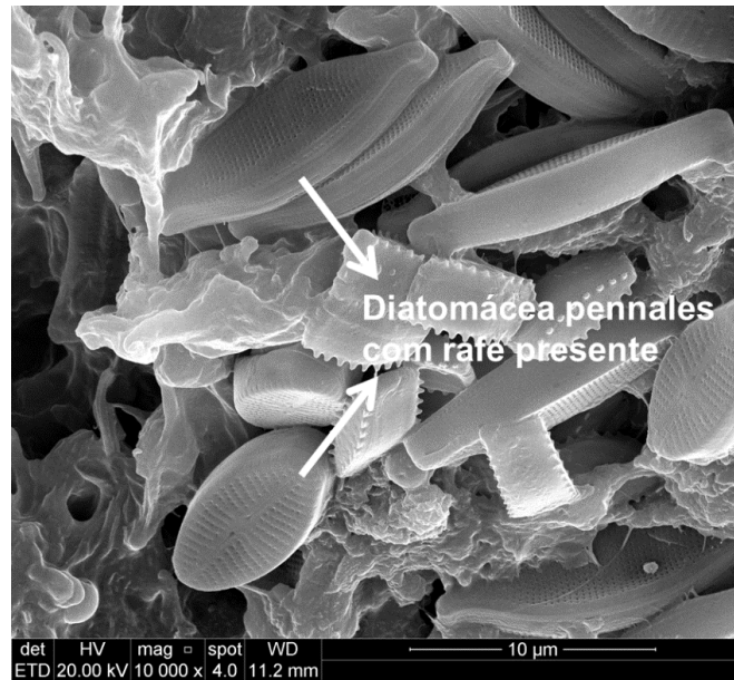
Figura 5.26. Imagens de MEV para a amostra PP-4%Eco-One após 90 dias exposta à água salina.
