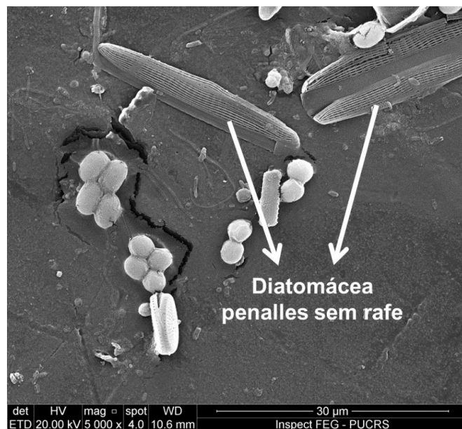
Figura 5.27. Imagens de MEV para a amostra PP-4%Eco-One após 180 dias exposta à água salina.
