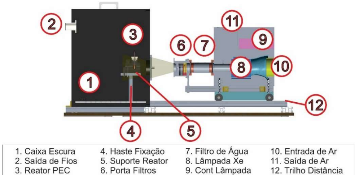
Figura 20. Simulador solar para medição fotoeletroquímica e seus componentes
