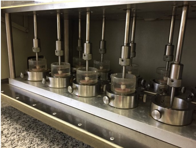
Figura 4. Corpos de prova durante o processo de ciclagem mecânica.
