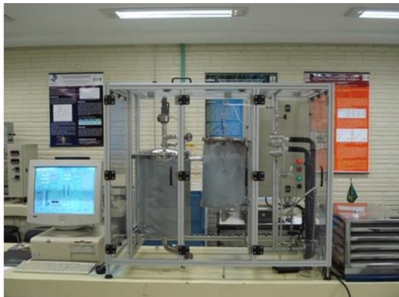
Figura 4.1. Unidade piloto de arraste a vapor.
