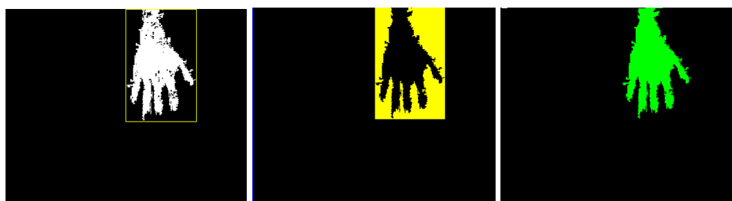
(a) Imagem de entrada. (b) Preenchimento do fundo. (c) Seleção de pixels de pele.
