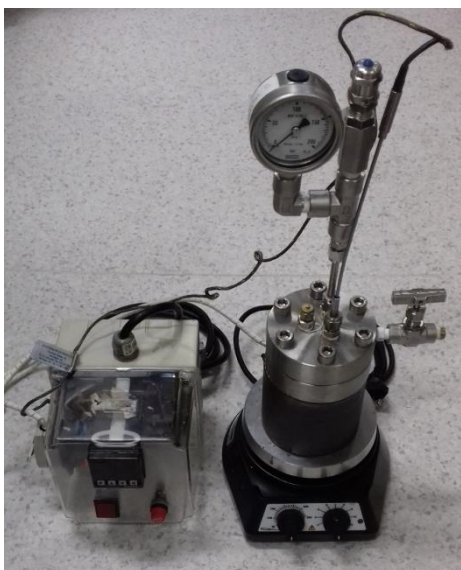
Figura 4.4. Sistema reacional utilizado equipado com agitação magnética e controle de temperatura.
