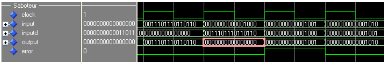
Figura 4. Exemplo de operação do módulo saboteur .
