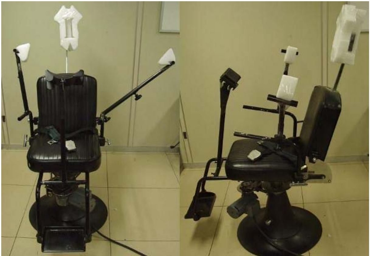
Figura 6.1. CBEC com suportes laterais para cabeça, adaptação para desenvolvimento de pesquisa entre o Laboratório de Microgravidade/PUCRS e o Johnson Space Center/ NASA
