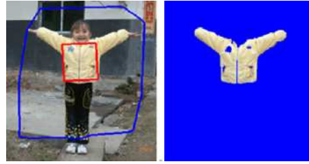
Figura 2.3: Ilustração do método proposto por Hu [6] e sua equipe. Imagem da esquerda: imagem de entrada com o tronco detectado (em vermelho) e limites da região do fundo estimada (em azul). Imagem à direita: resultado da segmentação.
