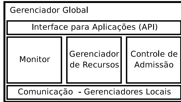
Figura 15: Arquitetura do Gerenciador Global.
