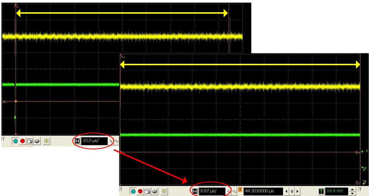
Figura 14 – Ajuste da “janela de tempo” ao visor do osciloscópio, através da configuração da escala horizontal.
