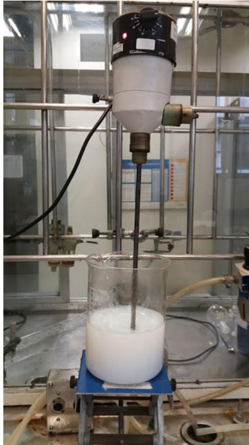
Figura 4.8. Imagem do sistema utilizado para a dispersão do pré-polímero em água e extensor de cadeia.
