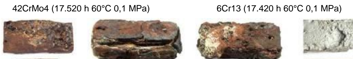
Figura 3.16. Imagens de superfícies das amostras expostas ao meio aquoso saturado com CO 2 em aquífero salino, a 60°C em pressão ambiente. Fonte: Adaptado de Pfening et al. (2011).
