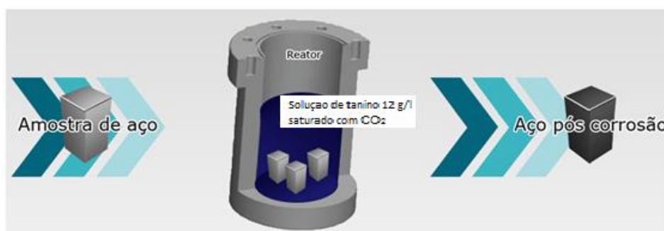
Figura 4.5. Desenho esquemático do vaso de pressão em corte longitudinal, ilustrando a distribuição dos corpos de prova em água saturada com \text{CO}_2 . Fonte: Adaptado de Lopez, 2017.
