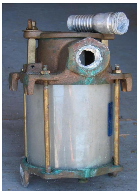
Figura 3.3. Corrosão galvânica devido ao contato do bronze com o alumínio na parte de um equipamento utilizado na produção de óleo e gás. Fonte: Popoola et al. (2013).
