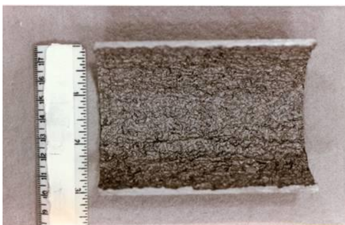
Figura 3.7. Corrosão uniforme em aço por CO 2 . Fonte: Go-Tech (2015).
