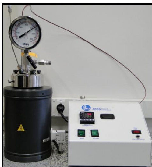
Figura 4.4 Reator de aço inoxidável AISI 316L utilizado para os ensaios de corrosão em meio aquoso com CO 2 a alta pressão e alta temperatura.
