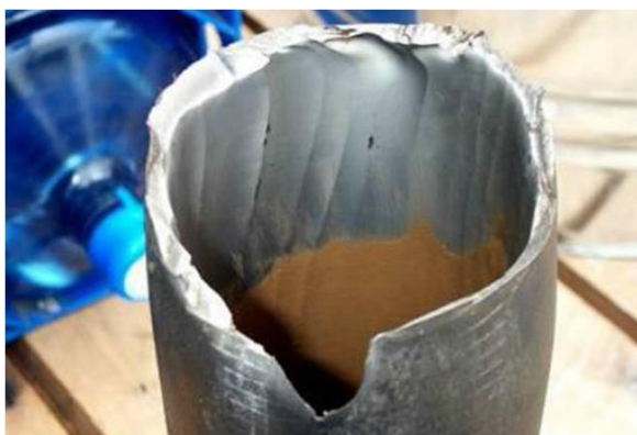
Figura 3.6. Corrosão sob tensão em duto. Fonte: Popoola et al. (2013).
