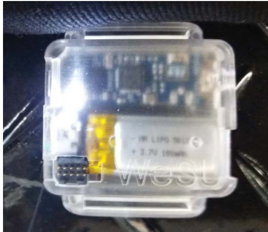
Figura 31: Módulo LSM6DS3 utilizado para medição de aceleração.
