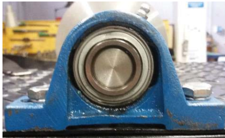
Figura 16: Mancal de unidade de bloco do tipo almofada
