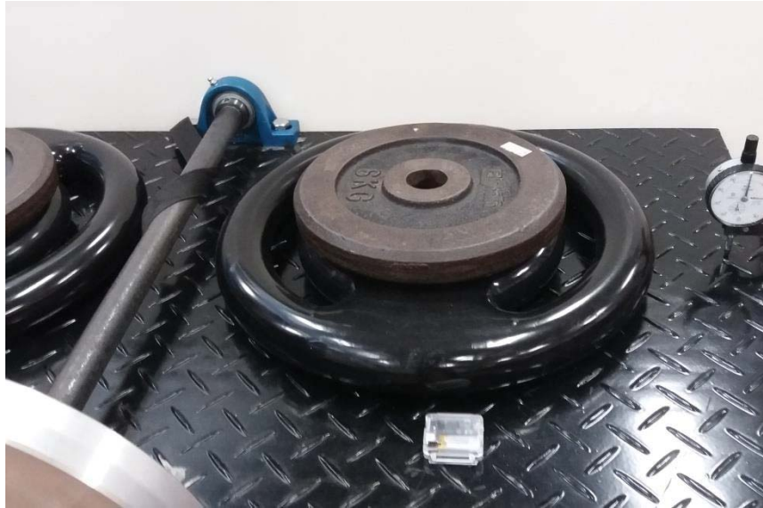
Figura 32: Teste da plataforma com carga de 52 Kg
