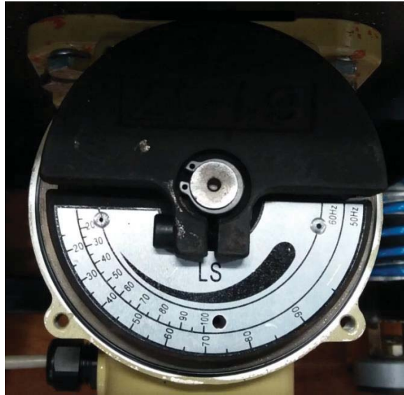
Figura 29: Motovibrador regulado para mínima intensidade de vibração
