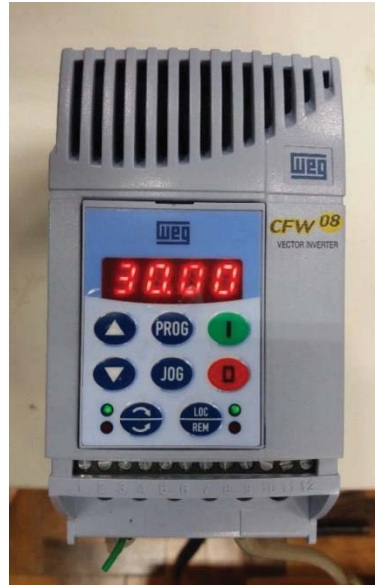
Figura 26: Inversor de frequência WEG – CFW08
