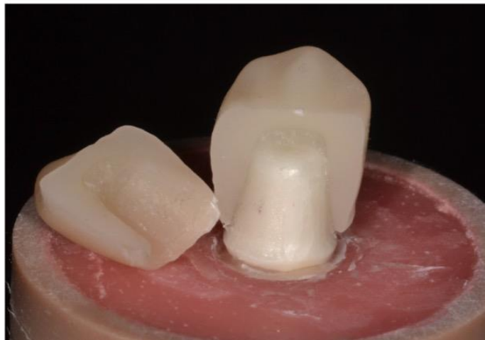
Figura 3. Corpo de prova do grupo coping + e.max CAD após o ensaio de resistência à fratura
