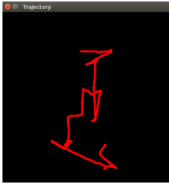
Figura 2: Resultado da Odometria Visual utilizando o detector de Harris a 15 FPS e calibração com plano xadrez
