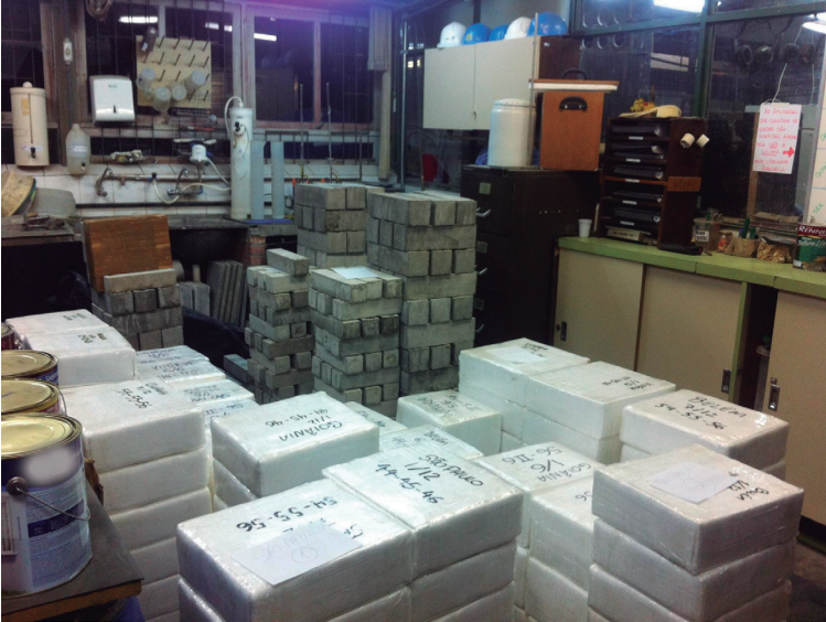
Figura 4. Corpos de prova produzidos em Porto Alegre para remessa aos locais de exposição, com o objetivo de aferir os modelos de previsão da vida útil de estruturas para a realidade brasileira.
