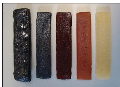
Figura 2 - Amostras submetidas à ação térmica em 260°C, 240°C, 200°C, 160°C e 80°C.
