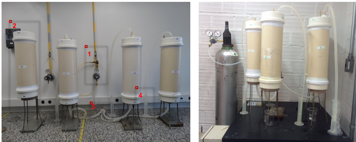
1 - Fluxômetro de CO 2 ; 2 - Coluna sem injeção de CO 2 ; 3 - Dispensor de CO 2 ; 4 - Borbulhamento de CO 2
