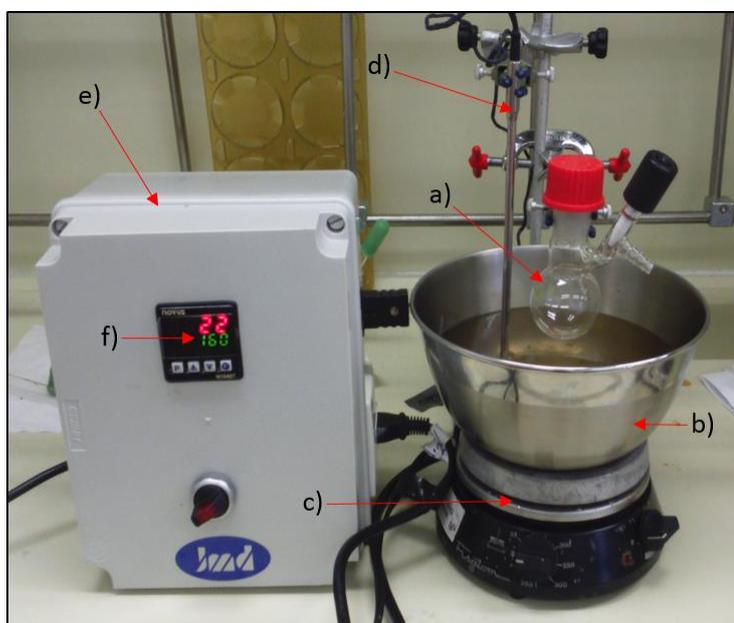
Figura 4.1. Sistema de síntese dos nanofios de prata, sendo a) o balão de 50 mL onde ocorre a síntese, b) banho de óleo, c) agitador magnético com aquecimento, d) termopar tipo J, e) sistema PID da NOVUS, modelo N1040T e f) o visor de temperatura do sistema PID em °C (o número verde representa a temperatura de set point e o vermelho a temperatura atual do óleo).
