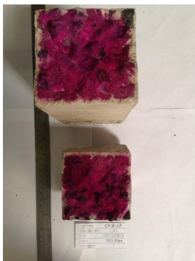
Figura 4 – Corpo de prova CP III – AF, a/c= 0,55 que recebeu aspersão de fenolfetaleína.
