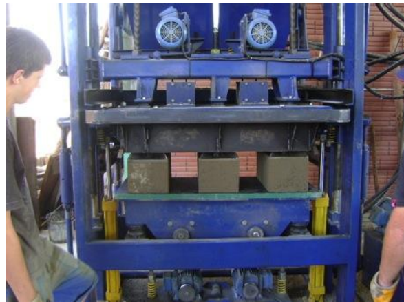
Figura 8 – Parte do processo automatizado moldagem dos blocos
