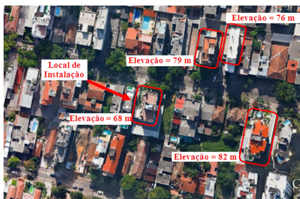
Figura 9: Edificações com elevação superior ao plano de instalação.
