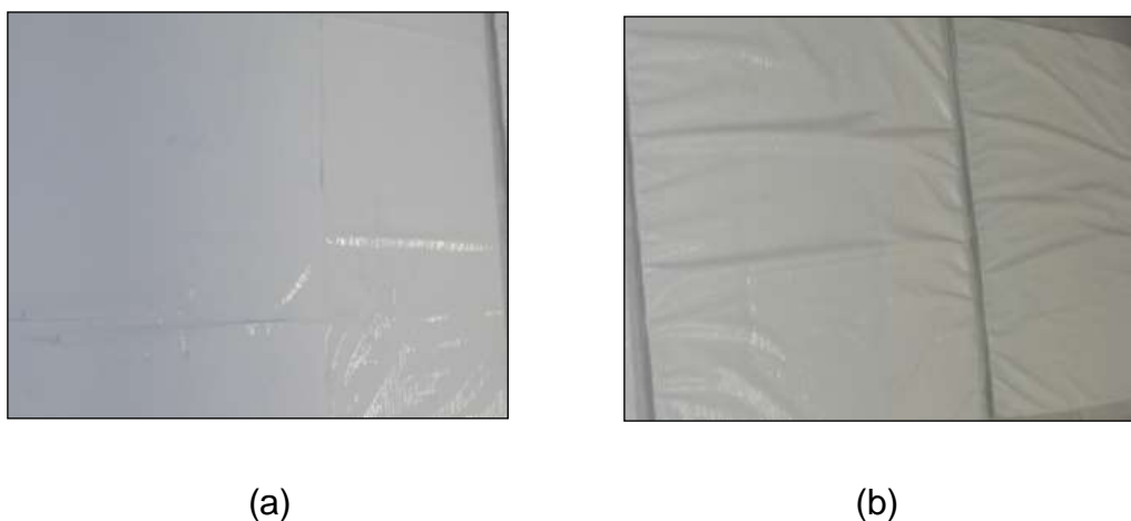
Figura 4.2. Filme resultante de três aplicações de tinta mostrando enrugamento: (a) produzido sobre o substrato de PVC < 1,8 mm e (b) produzido sobre com papel celofane.
