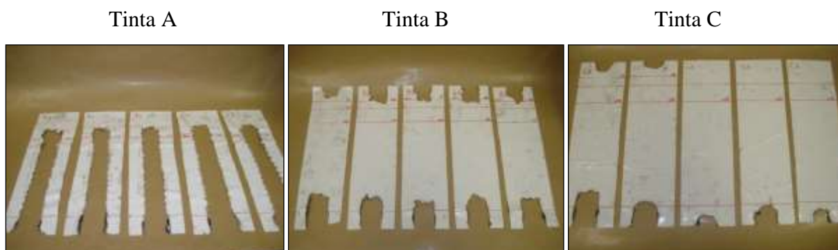
Figura 5.2. Vista da extensão de queima sequencial das amostras dos filmes ensaiados, abrangendo cinco repetições para cada Tinta – A, B e C, pela NBR 14892/02.
