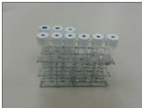
Figura 4.10. Frascos coletores de 15 ml utilizados para coleta da fumaça.
