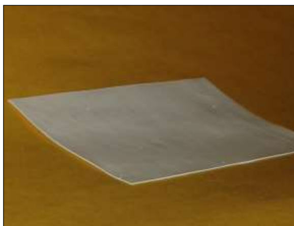
Figura 4.1. Filme de tinta resultante de três aplicações produzido sobre o substrato de PVC 1,8 mm, utilizado para os testes.
