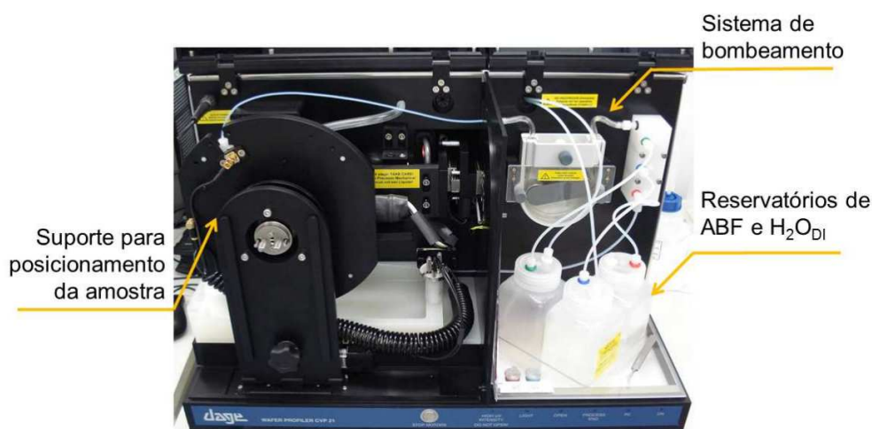
Figura 3.14 . Equipamento Wafer Profiler CVP21 , utilizado para a medição do perfil de dopagem (Garcia, 2016).
