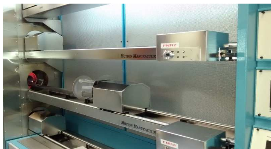
Figura 3.7. Forno de difusão do laboratório do NT-Solar.
