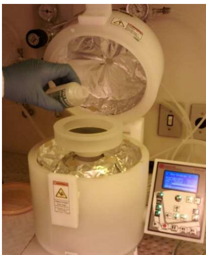
Figura 3.6. Spinner para deposição do dopante em forma líquida.
