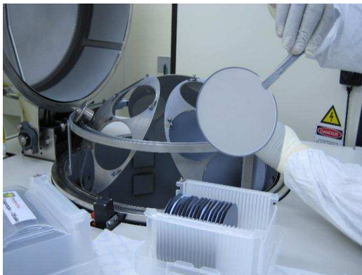
Figura 3.8. Deposição do filme antirreflexo no laboratório do NT-Solar.
