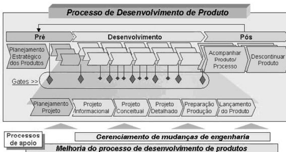
Figura 2: Processo unificado de desenvolvimento de produtos
