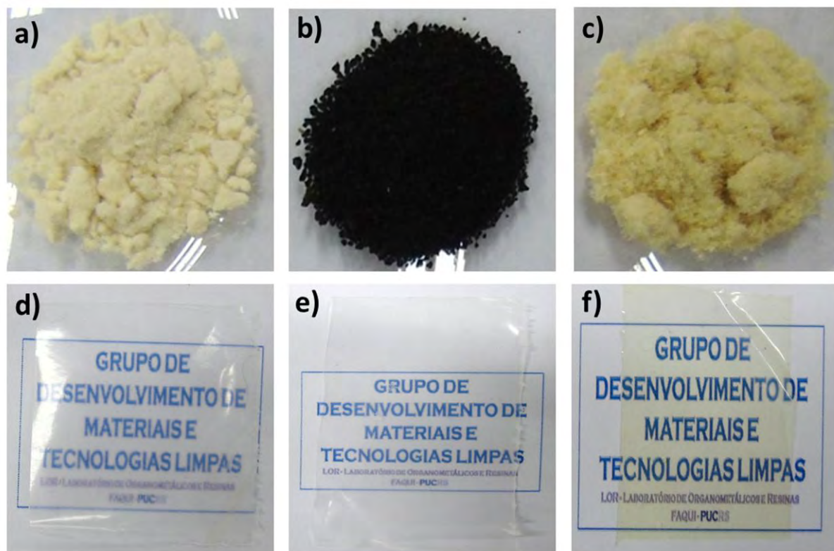
Figura 5.1. Imagens ópticas obtidas para os melhores materiais de cada grupo: a) CL-TBA, b) [\text{CeEt}_3\text{N}][\text{PF}_6] ; c) CL-D400; d) PU-TBA; e) PU-TBP e f) HPIL-02-TBA.
