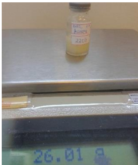
Figura 4. Exemplo de verificação do volume do leite coletado: a balança marca 26,01 g e o frasco mostra a anotação de 22,07 g. A diferença indica que o peso do leite coletado é de 3,94 g, correspondente ao volume de 3,94 mL.
