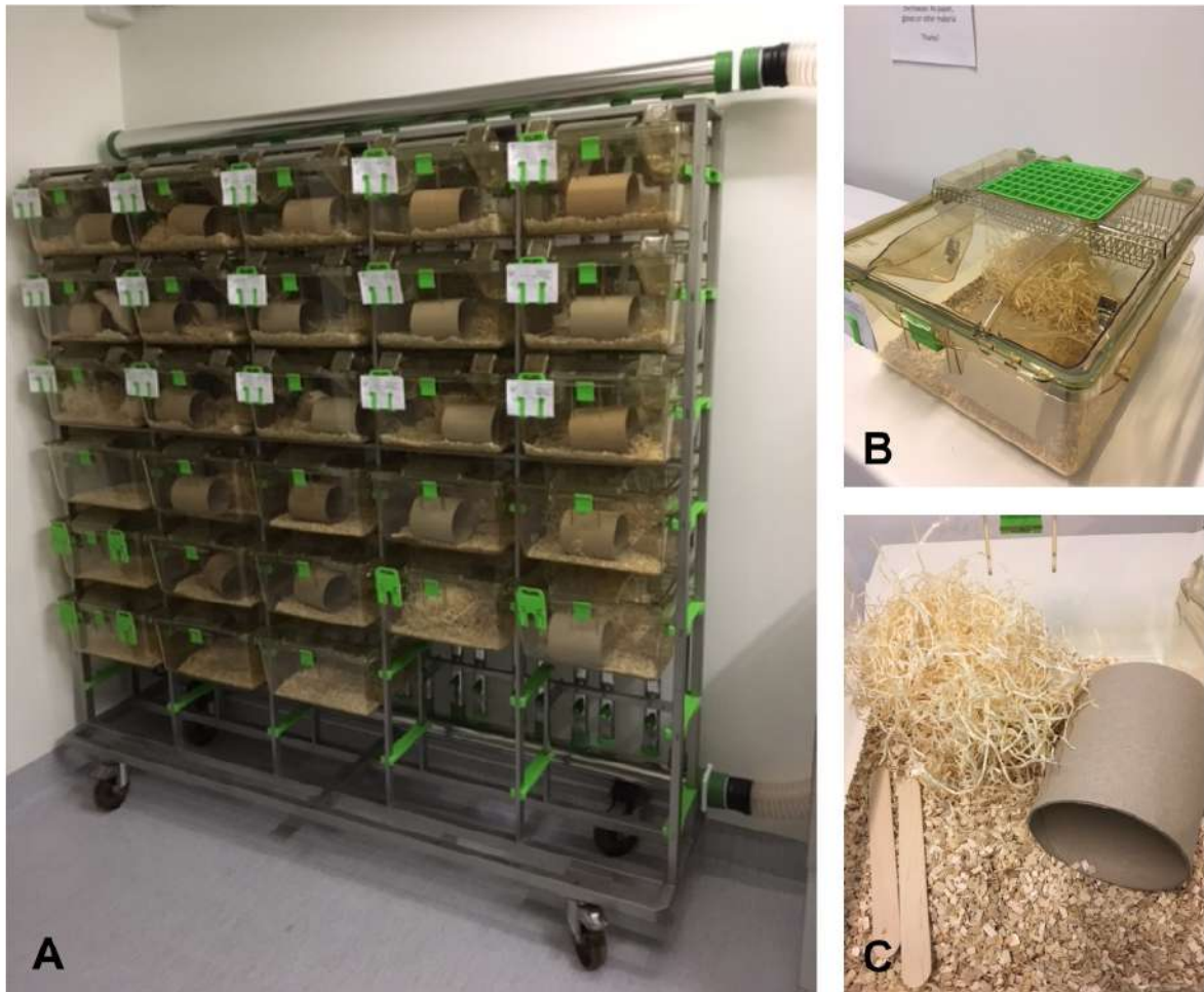
Figura 6. Acondicionamento animal. Note em A – caixas acrílicas dispostas nos racks ventilados; B - caixa padrão com tampa fechada utilizada para manter os ratos durante a realização do experimento. Nesta é possível verificar os espaços onde foram inseridos os bebedouros (localizadas na parte frontal da tampa da caixa, um ao lado direito e outro no lado esquerdo) bem como a ração peletizada (na estrutura de metal aérea localizada aos fundos, no interior da caixa); C - caixa aberta, onde é possível observar o enriquecimento utilizado em cada uma das caixas dos animais.
